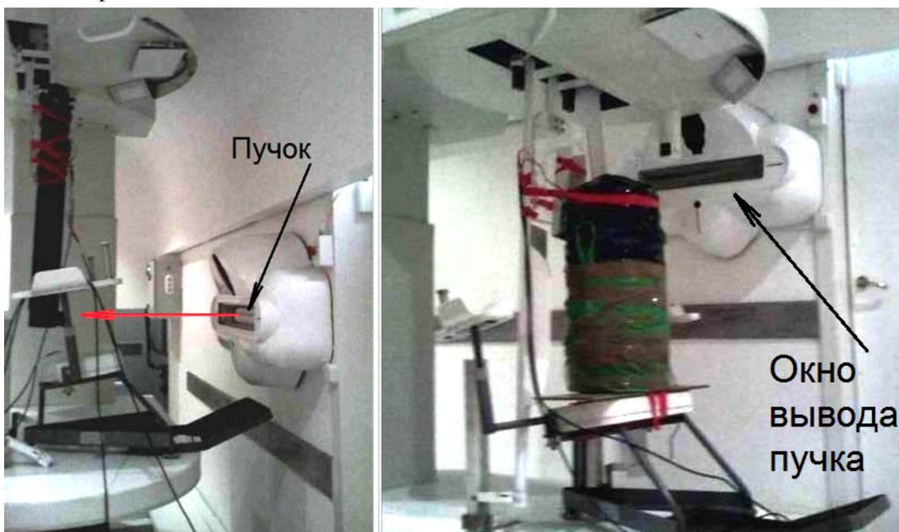
Рис. 2. Кресло пациента с кюветами диаметром 100 мм (слева) и 280 мм (справа).
