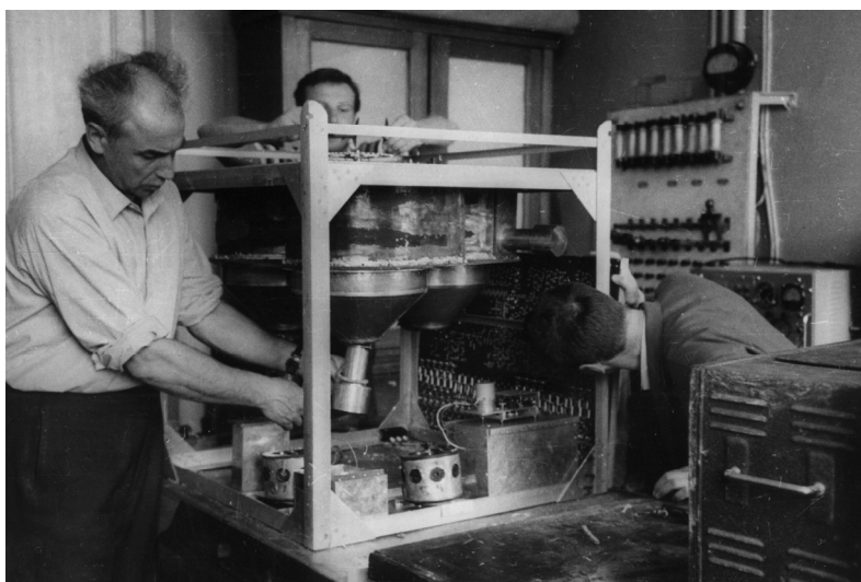
Рис. 14. Изготовление прибора по регистрации высокоэнергичных галактических электронов на больших высотах в атмосфере. Слева - руководитель работы к.ф.-м.н. с.н.с. В.И. Рубцов.
