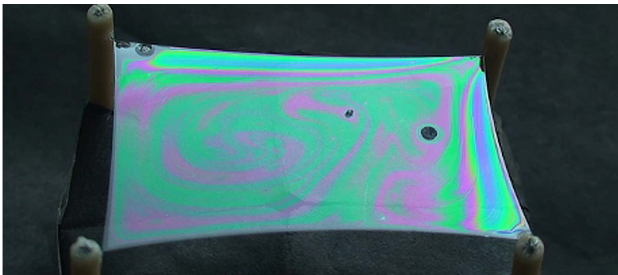
Рис.13. Испалатор с бегающими потоками ( глицерин и вода).
