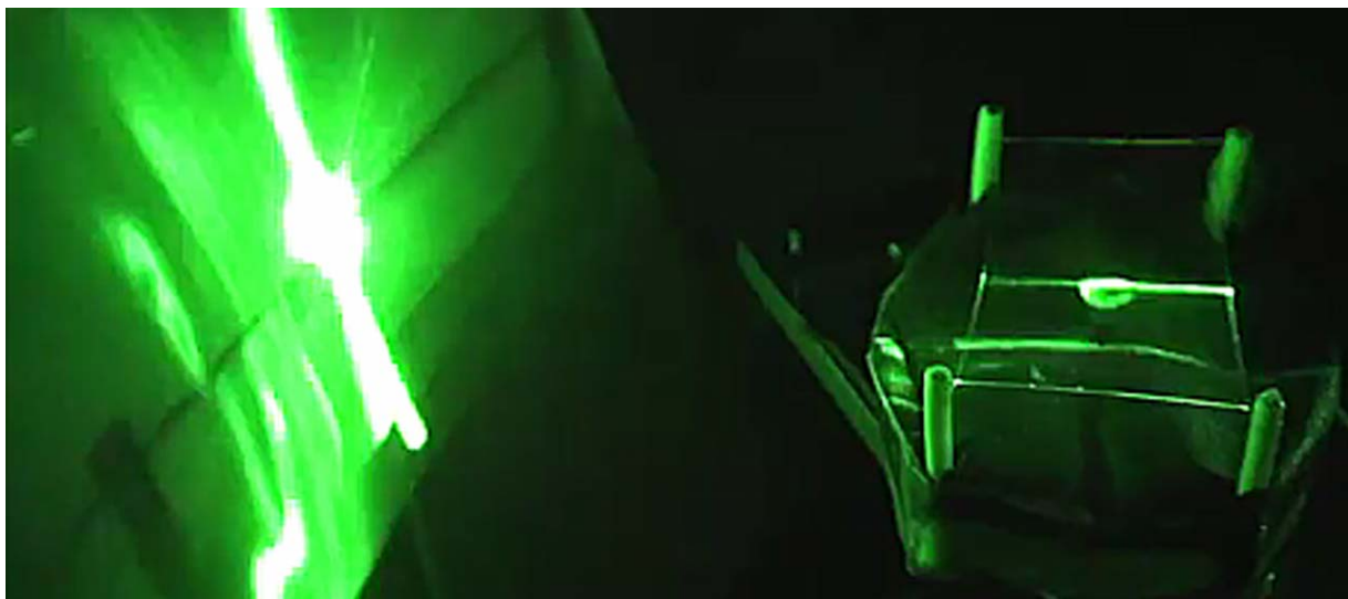
Рис.17. Зеленые полосы на экране (с каплей воды на пленке).
