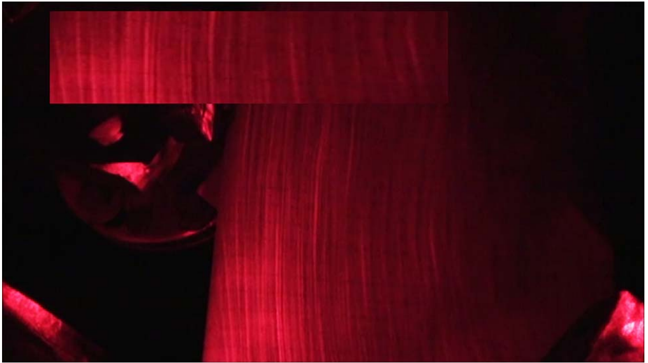
Рис.6. Вид бегающих полосок выходного излучения треков на экране на расстоянии 25 см от края пленки.0122. Между проступающими горизонтальными темными линиями 5 мм.
