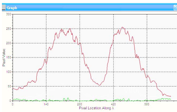
Рис.8. Распределение интенсивности в полосках излучения запредельных треков, не дошедших до края пленки.
