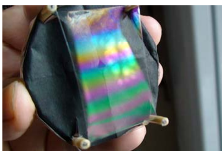
Рис.2. Вертикальная мыльная пленка на рамке 3 х 5 см с радужными полосками на ней.
