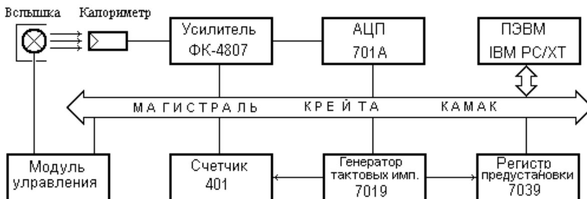
Рис.9. Схема измерения функции отклика калориметров.
