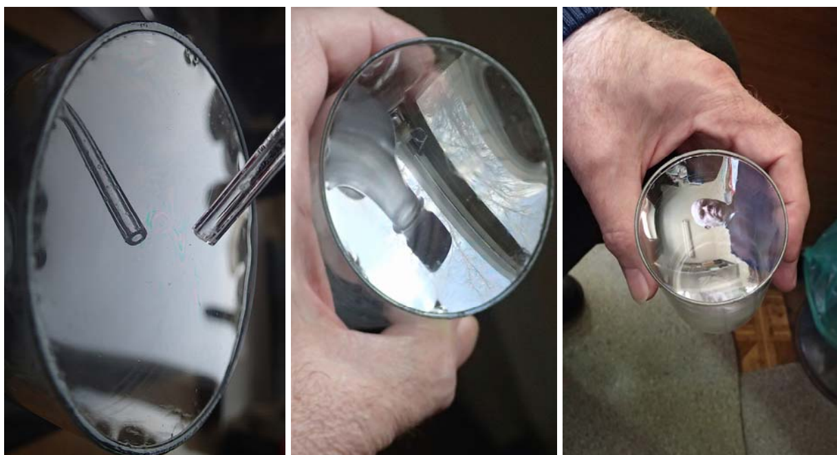
Рис. 2. Зеркальное отражение от застывшей мыльно-желатиновой пленки диаметром 57 мм разной кривизны.
