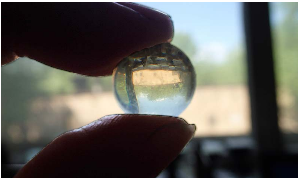
Рис.5. Полученная на пленке (Рис.4) самодельная эпоксидная линза диаметром 16 мм с фокусным расстоянием 5 мм.
