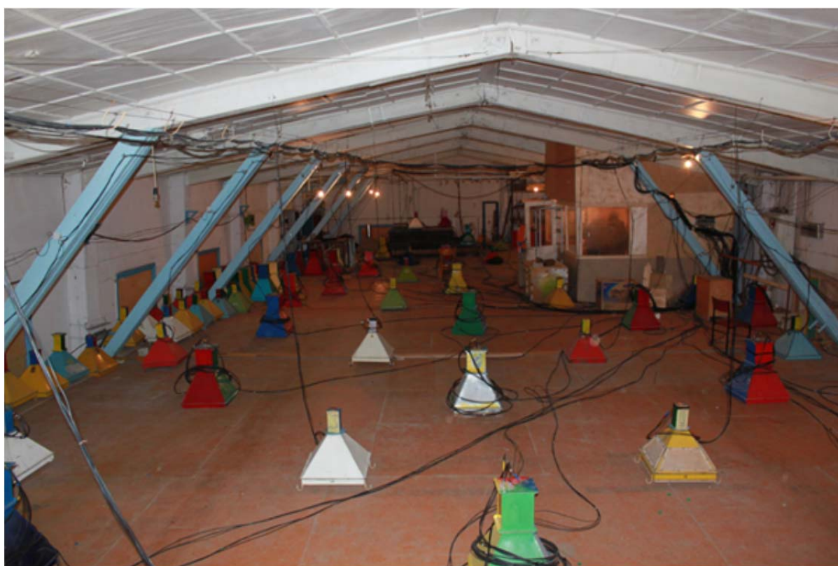
Сцинтилляционные детекторы для регистрации электронно-фотонной компоненты.
