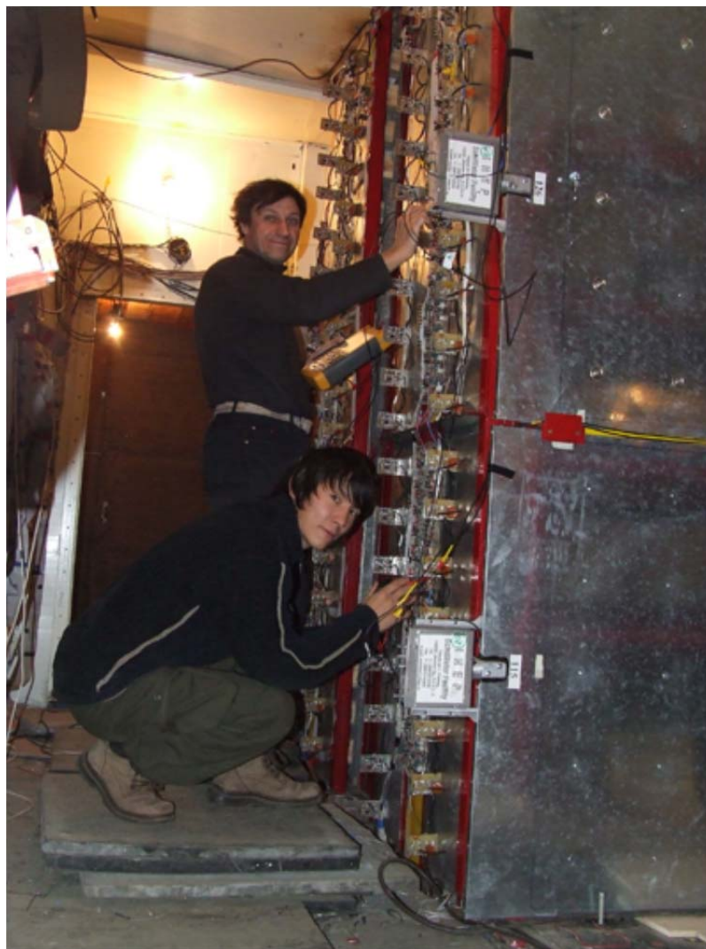
Настройка каналов подземного нейтронного калориметра ( "UNCA-152" ) и для регистрации нейтронных «толчков» от горизонтальных мюонов.
