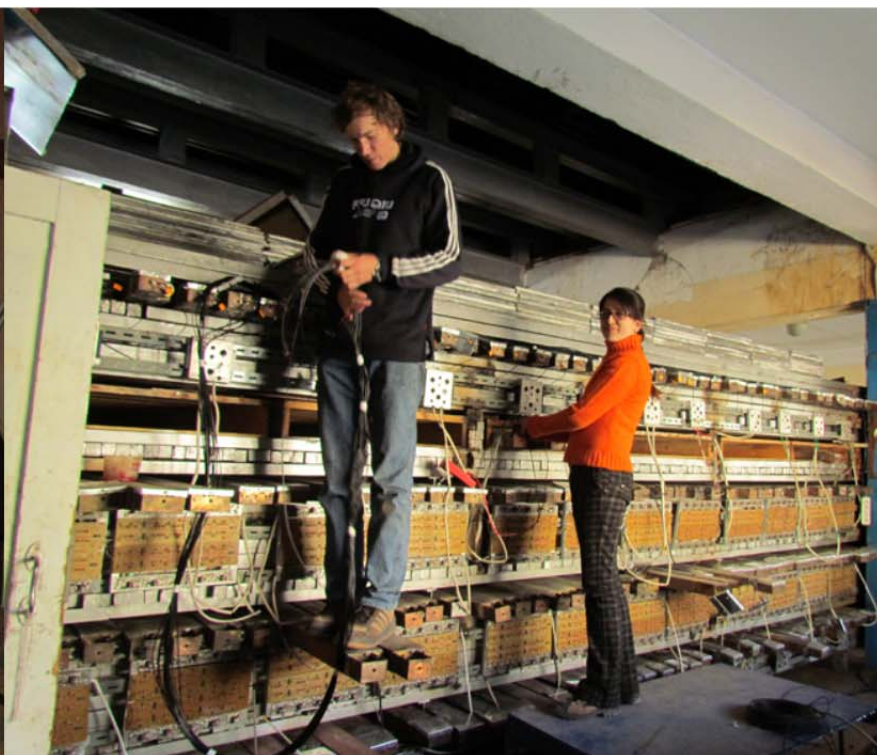
Подземный 2-х секционный нейтронный детектор для регистрации нейтронных «толчков» от вертикальных мюонов.
