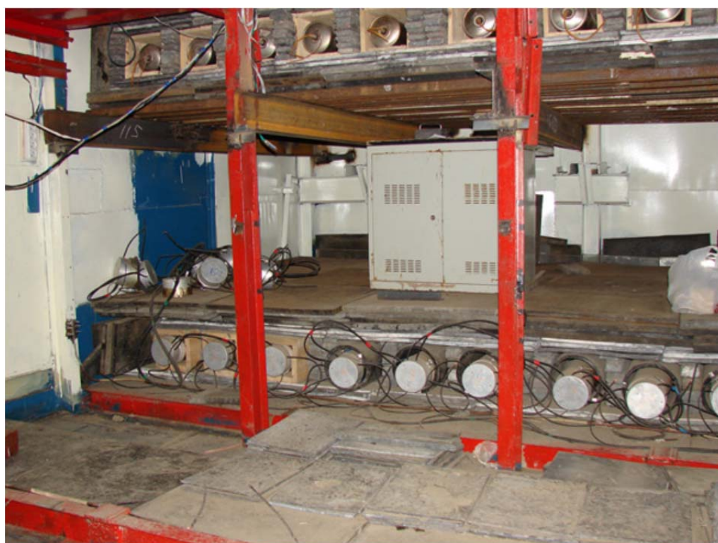
Подземный детектор для регистрации нейтронных «толчков» от мюонов.
