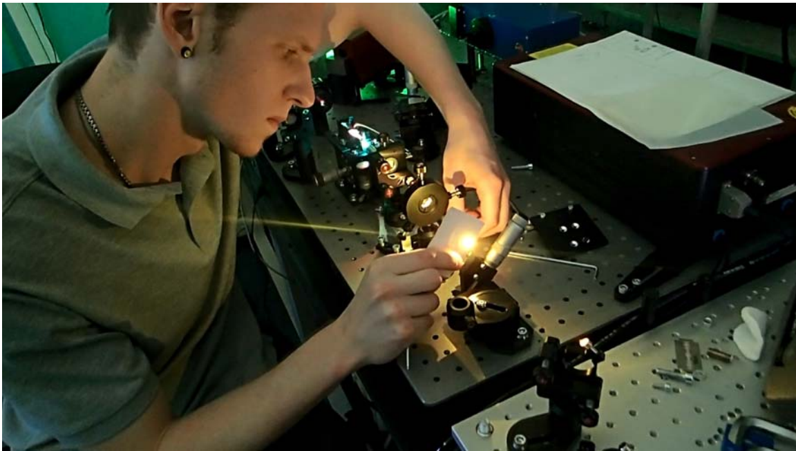
Рис.7. Получение белого света с использованием лазера "TiF-50 mini"
