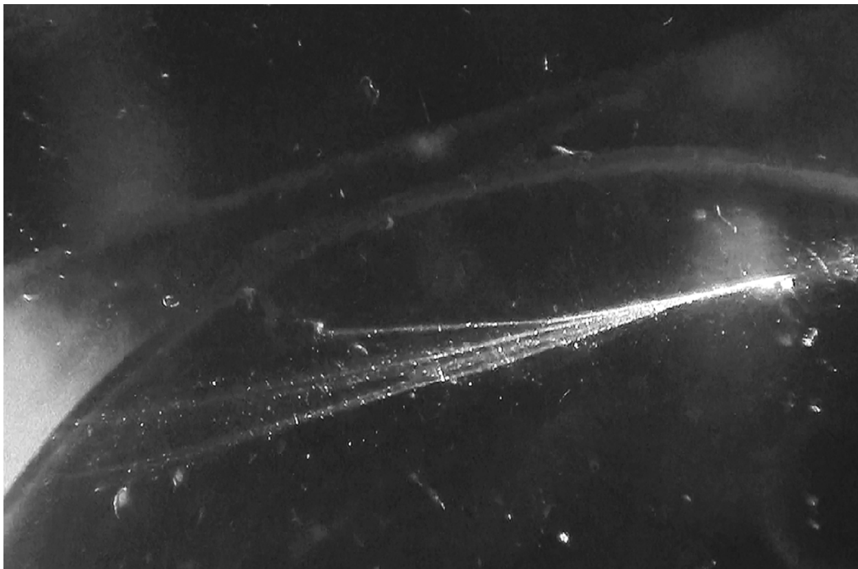
Рис.2. Лазерные треки в пленке бензина на кварцевой подложке.
