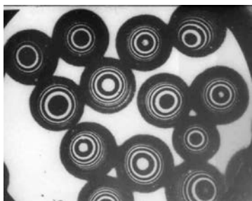
Рис. 51. Фотография на интерферометре оболочек диаметром 150 мкм в США
