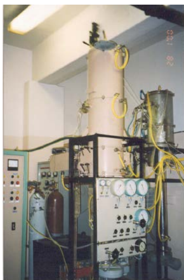
Рис. 107. печь падения для изготовления стеклянных оболочек диаметром до 1.2 мм
