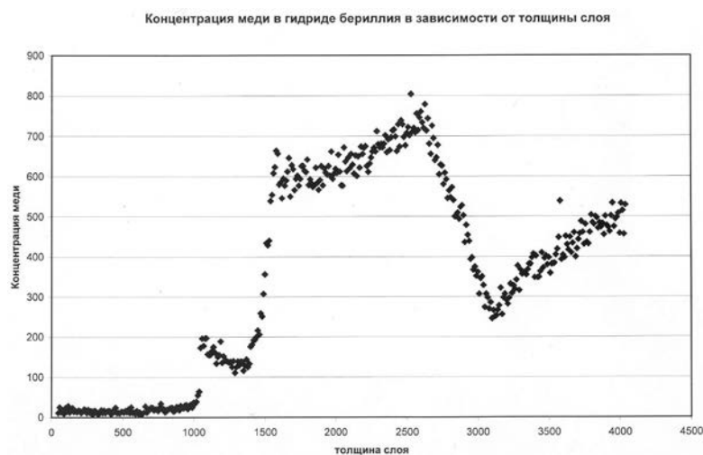
Рис. 154. Распределение меди по толщине слоя BeD 2 . Полная толщина около 9 мкм. В максимуме 12% вес.
