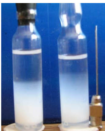
Рис. 151. Два образца геля \text{SiO}_2 после выдержки 10 часов.
