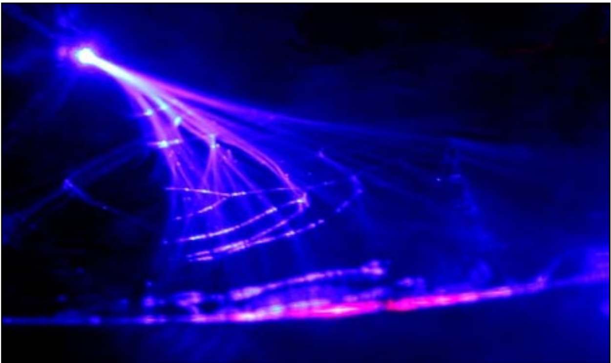
Рис.10. Вид усов поверхностного поляритонного излучения в горизонтальной мыльной пленке длиной 2.5 см толщиной около 50 нм при фокусировке на край пленки излучения непрерывного Cd-лазера 441.6 нм с мощностью 5 мВт.
