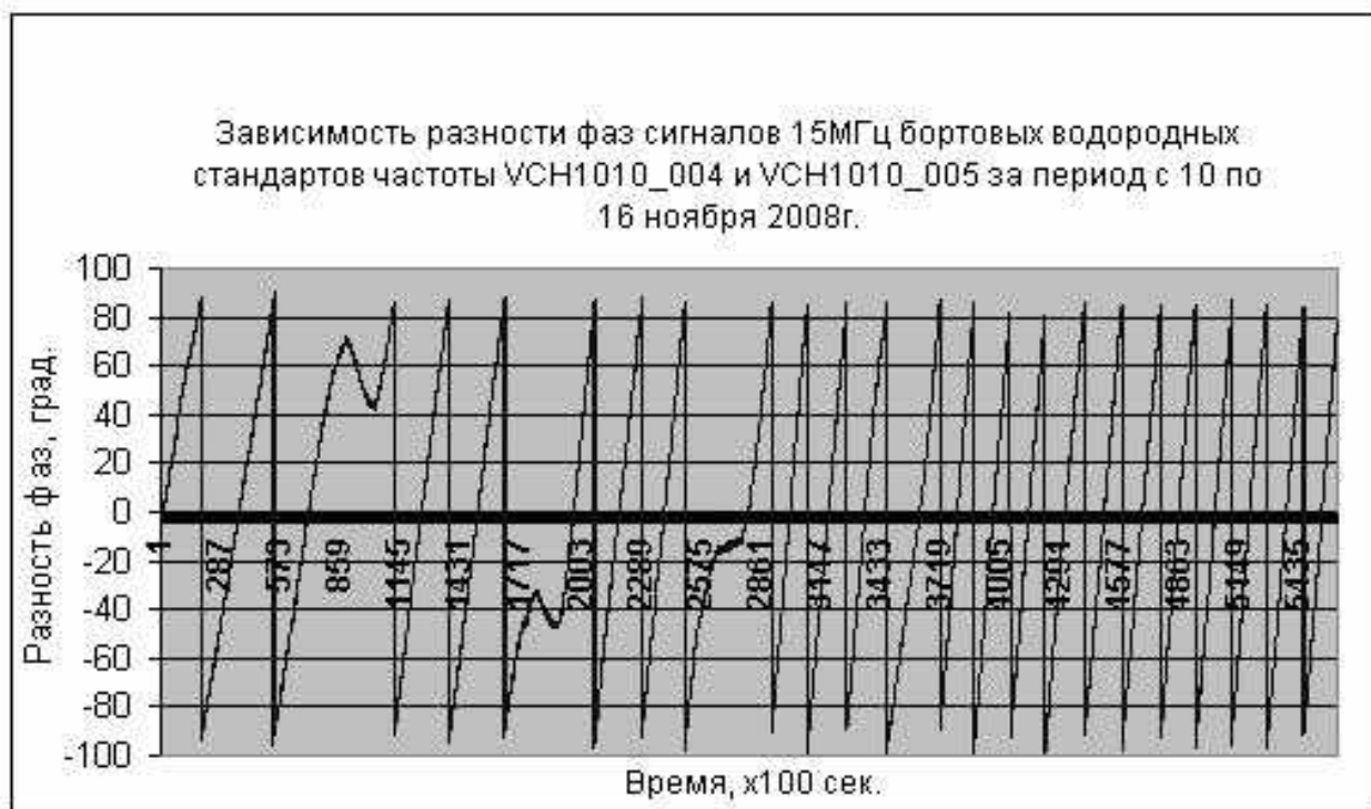
Рис. 14. Зависимость разности фаз сигналов БВСЧ от времени.
