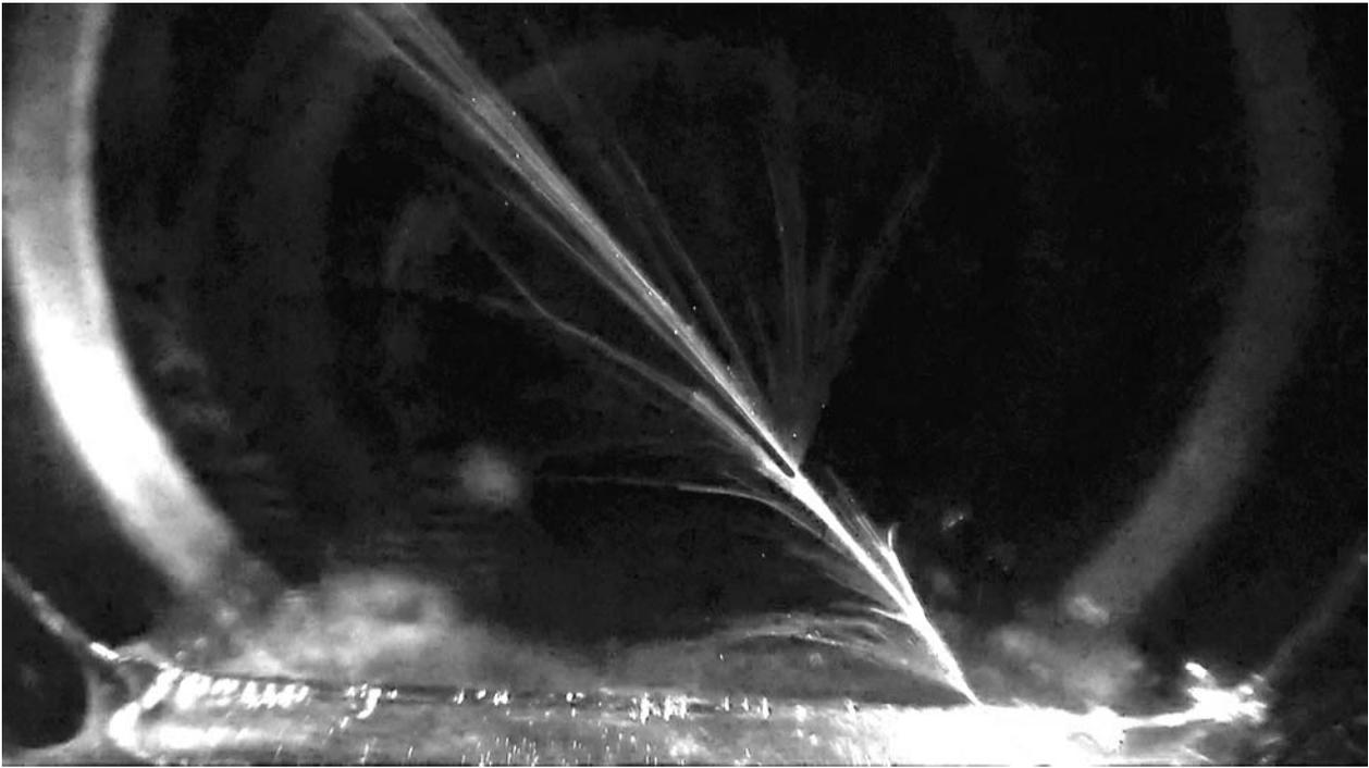
*Рис.9. Рождение треков в более тонкой части пленки.*
