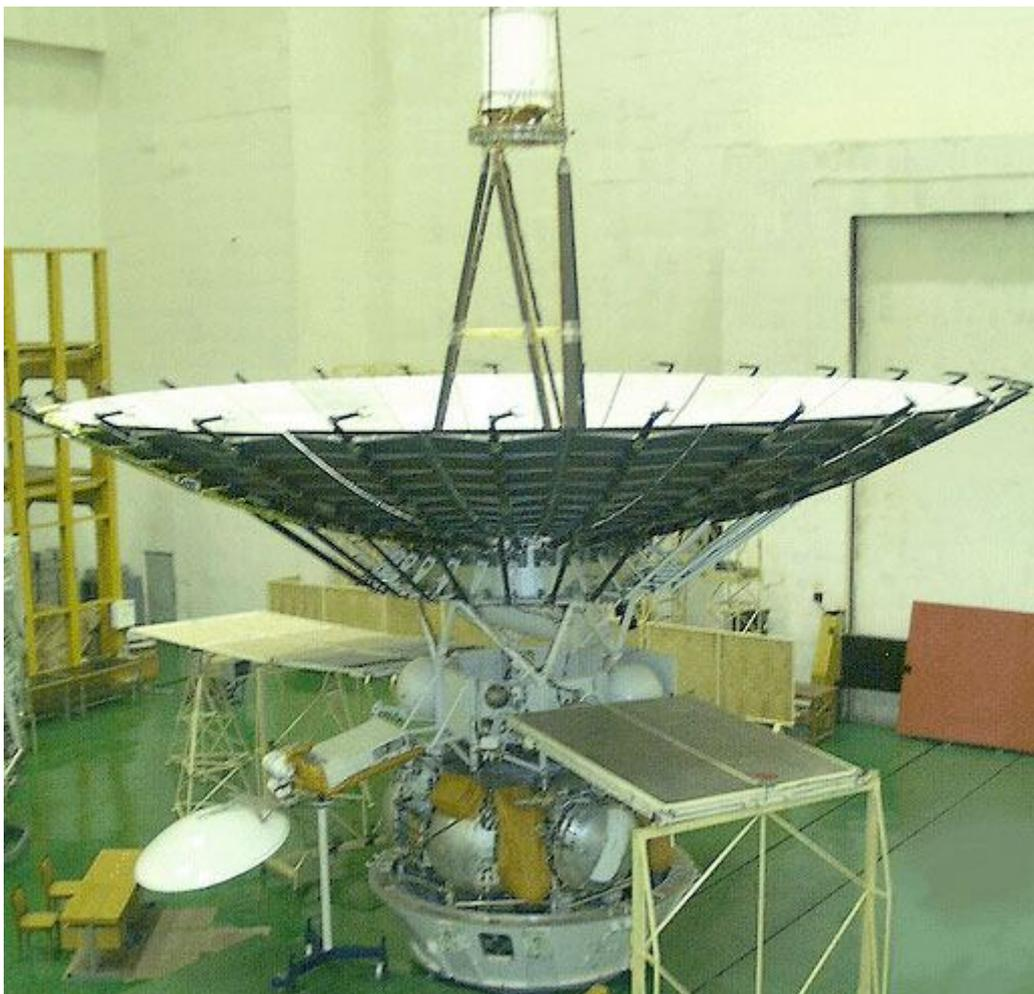
Рис. 9. Фотография спутника «РАДИОАСТРОН» для наземно-космического радиointерферометра
