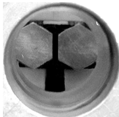
Рис.5. Вид на электродную систему А через выходное окно разрядной камеры (без зеркал резонатора).
