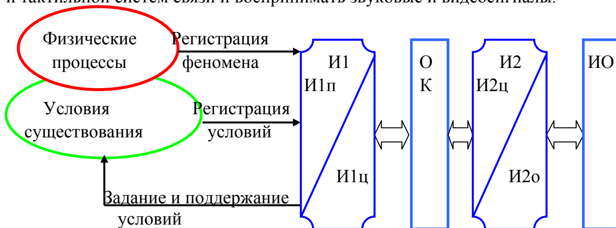
Рис. 1 Обобщённая схема АСНИ в экспериментальной физике
