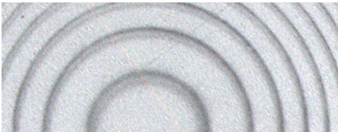
*Рис. 5. Интерферограмма спектра ВГР в исходном (незаполненном молекулярной жидкостью) фотонном кристалле в сравнении со спектром генерации лазера на рубине ( $\lambda=694 \text{ нм}$ ) при геометрии рассеяния «назад» (см.рис.2).*
