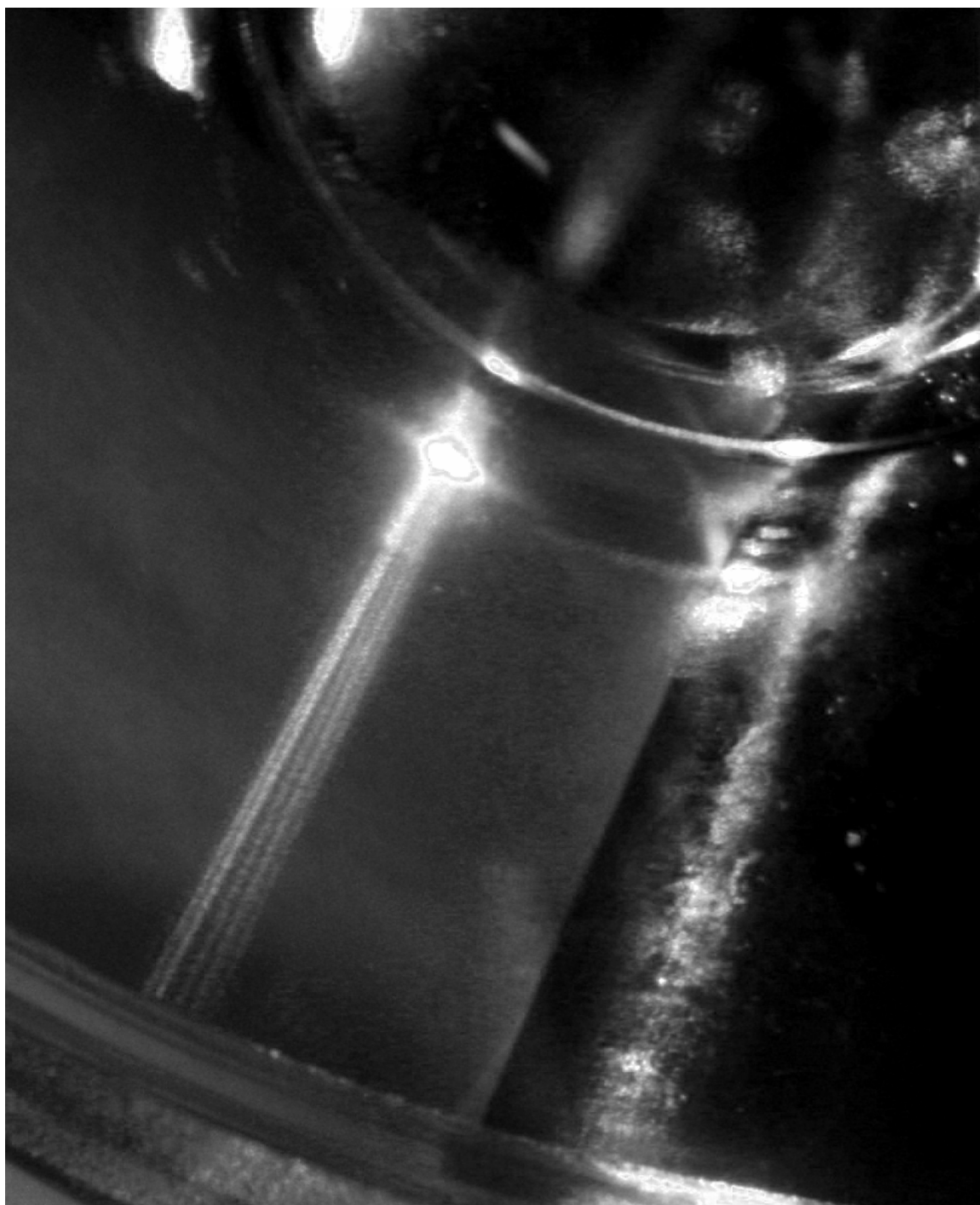
Рис.5. В черной сферической пленке излучение выходит из каждой точке трека по касательной к поверхности, образуя на экране около выходного пятна дополнительные яркие полосы.
