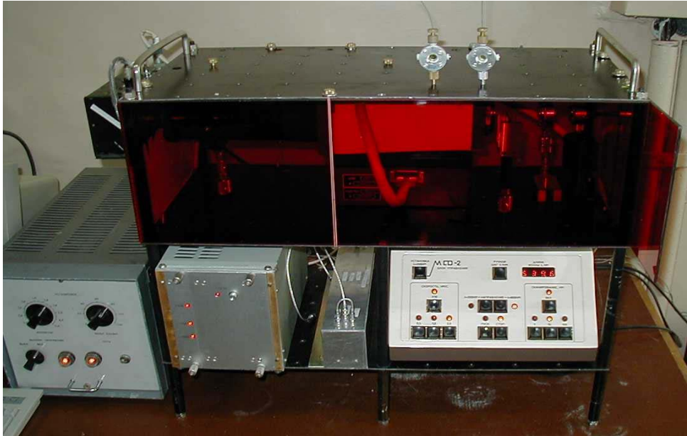
Рис. 13. Внешний вид спектрального блока с малогабаритным одинарным монохроматором типа МСД-2. В верхней части блока находятся световодные металлические кюветы.
