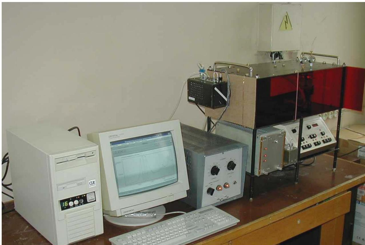
Рис. 12. Спектральный блок с компьютером.
