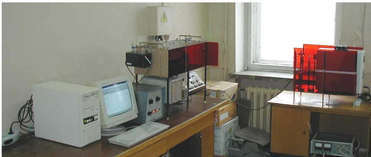
Рис. 11. Общий вид установки для исследования объемного вторичного излучения в конденсированных средах при импульсно-периодическом лазерном возбуждении.
