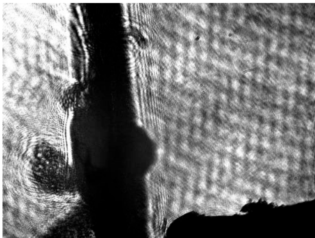
Рис. 8а. Теневая картина плазмы от мишени с плотностью 7 мг/см 3 и толщиной 280 мкм, энергия в выстреле 6.43 Дж, задержка 2.92 нс. Опыт №2 от 23.07.10.
