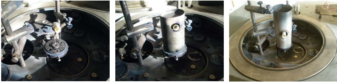
Испаритель металла: слева - керамическая трубочка испаритель, в центре - с одним тепловым экраном и справа - с двумя тепловыми экранами
